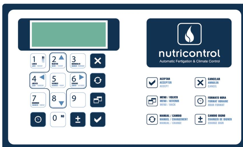
En ella puede apreciarse que el sistema dispone de un Display de 4 líneas y 20 columnas y un teclado de 16 teclas. En la imagen de arriba se pueden ver cuáles son las principales funciones de cada tecla. Además de estas, algunas teclas tienen dobles funciones tal y como se puede observar a continuación:
