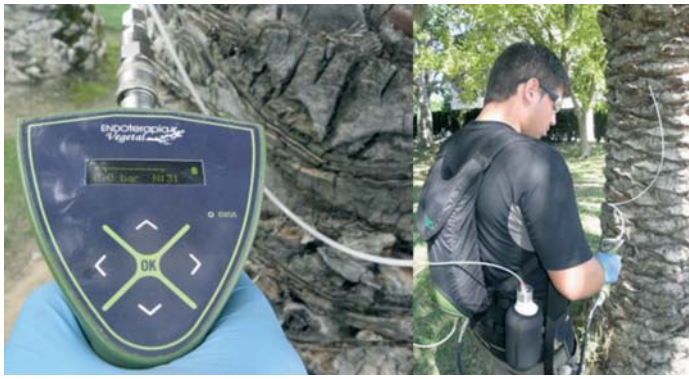
Figura 1. Nuevo sistema de micro-infusión a baja presión desarrollado por ENDOterapia Vegetal.
